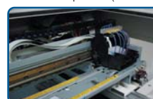
Tête d'impression avec nettoyage automatique en début et fin de cycle.
