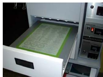
3 / a) positionner le positif avec la couche imprimée contre la face sensible du film lumière du jour. Recouvrir de la seconde plaque de verre.
