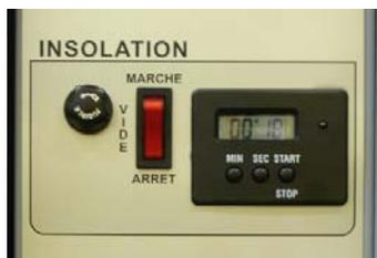
N.B en appuyant simultanément sur « MIN » et « SEC » la minuterie se remet à zéro.
