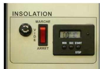
N.B en appuyant simultanément sur « MIN » et « SEC » la minuterie se remet à zéro.
