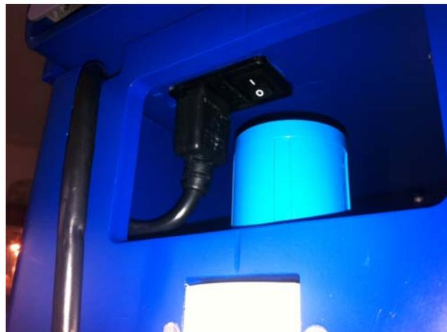
Quand la machine est mise sous tension, la lumière sous la machine et l’écran s’allument. Au bout de 12 secondes, une page d’introduction s’affiche avec le numéro de version du software et l’adresse de notre site.
