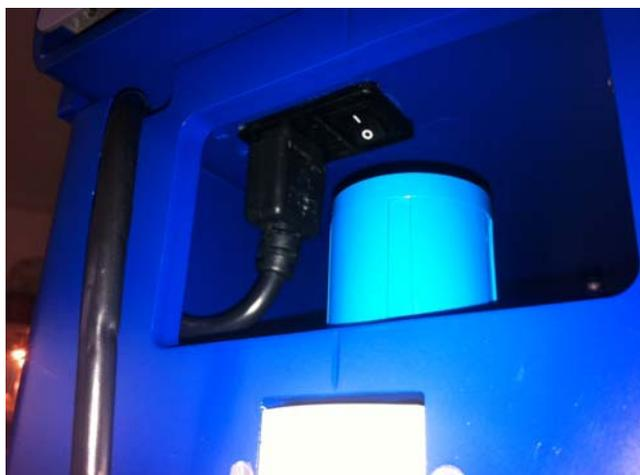
La photo ci-dessus montre l'emplacement du connecteur et comment le câble d'alimentation doit être installé.
