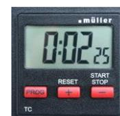
En appuyant deux fois sur la touche "PROG", le "00" des minutes clignote. le temps peut être ajusté au moyen des touches "+" et "-". le temps de polymérisation maximum ne doit pas excéder 10 minutes.
