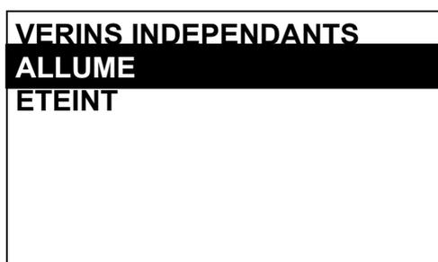
Avec cette fonction, l'utilisateur peut choisir de travailler ou non avec les vérins séparés. Si la fonction vérins indépendants est désactivée, la machine fonctionne comme une machine standard, tous les tampons descendent en même temps. Si la fonction vérins indépendants est activée, les tampons peuvent être commandés séparément, il est possible de régler leur hauteur pour chaque vérin.
