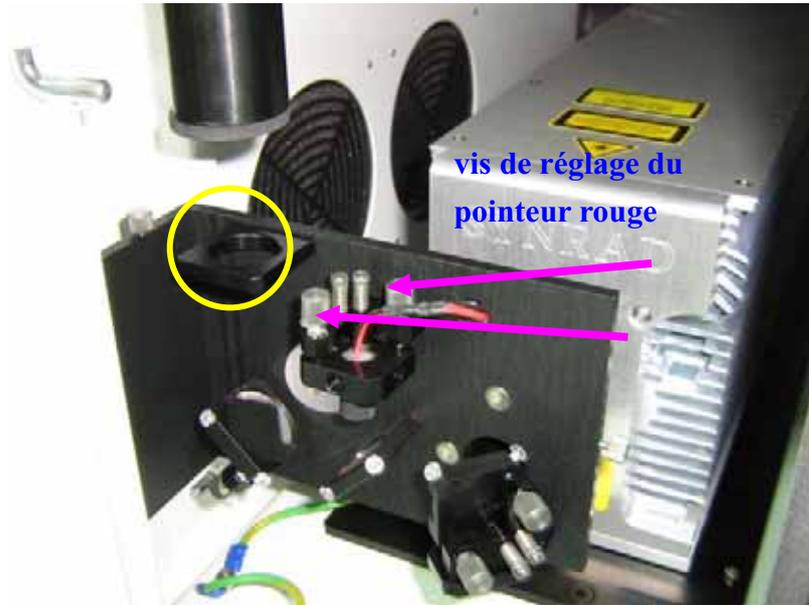
(1) Dévisser les deux vis et débrancher le tube d'air pour pouvoir soulever et retirer le cache du 3e miroir
