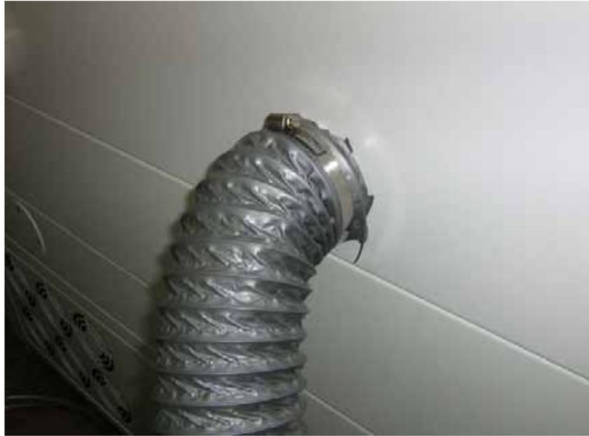
**5. Brancher le tuyau entre le filtre à air et le compresseur.**
