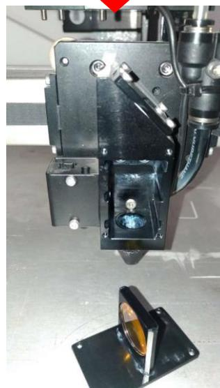
Nettoyer le 5e miroir et la lentille de focalisation et remettre en place. Remettre et revisser le cache.
