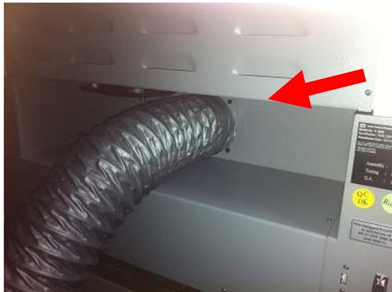
**5. Brancher le tuyau entre le laser et le compresseur**
