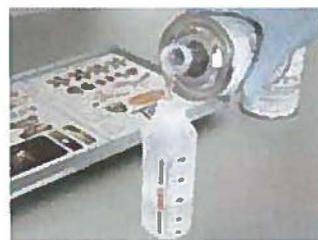
6. Verser la même quantité de chacun des 2 composants (résine d'abord) dans l'applicateur à l'aide des graduations ou en les pesant avec une balance digitale précise.
