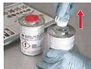
4. Ouvrir le flacon en soulevant le bouchon par les 2 ailes.
