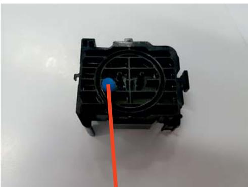
Changer le clapet et vérifier que l'obstructeur est présent sur le nouveau clapet
