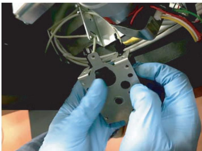
Remplacer la pompe et raccorder les tuyaux comme il faut
